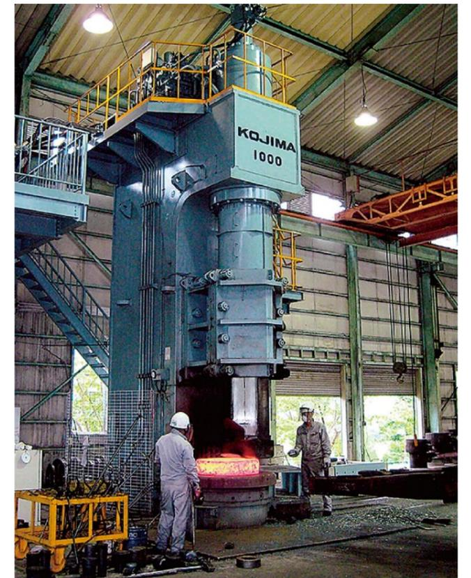
1,000T C型高速油圧式鍛造プレス/50~60S.P.M
