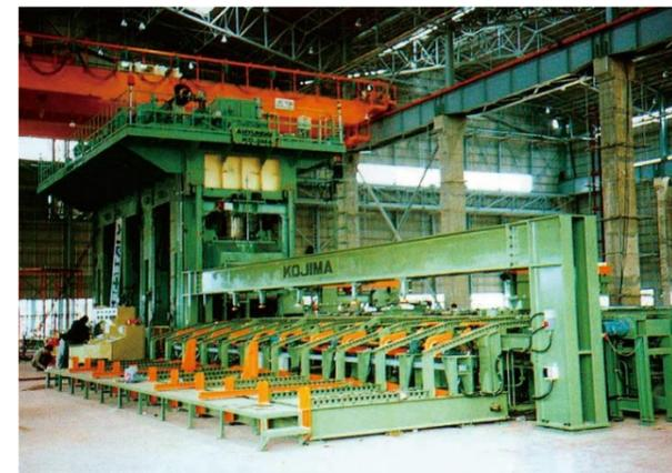
5,000T シャーシ成型プレス及び材料挿入・製品
