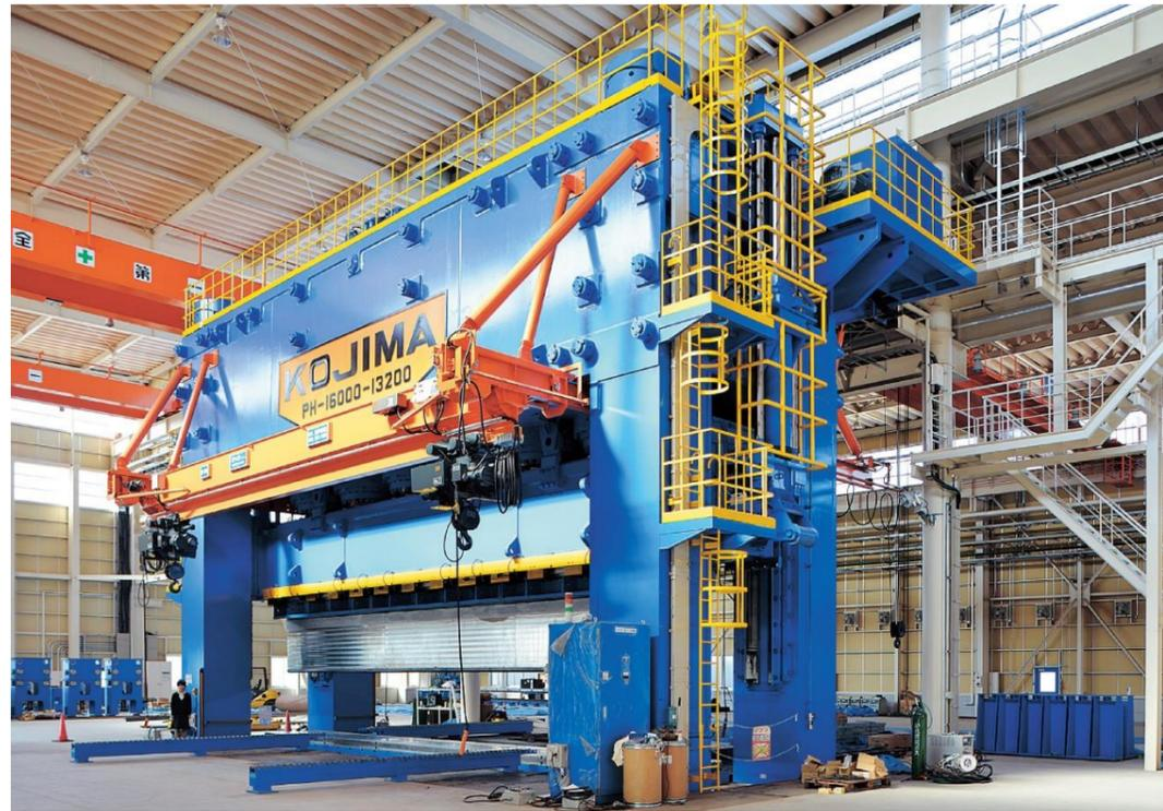
16,000T 長尺成形プレス テーブル 13,500×1,700mm
