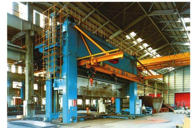
5,000T サイドフレーム型長尺成形プレス/UO曲げ
