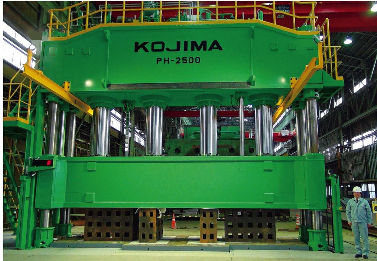
2,500T 四柱四筒式油圧プレス テーブル 7,500×1,800mm
