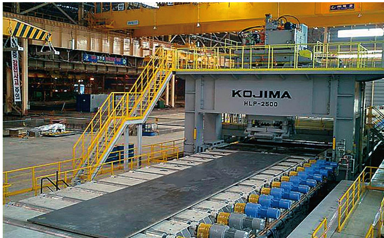
2,500T プレスレベラー 2,500T Press Leveler with Flatness Gauge
