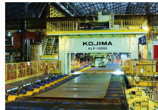
1,500T プレスレベラー テーブル 5,000 × 3,200mm 1500T Press Leveler Table Size 5,000×3,200mm
