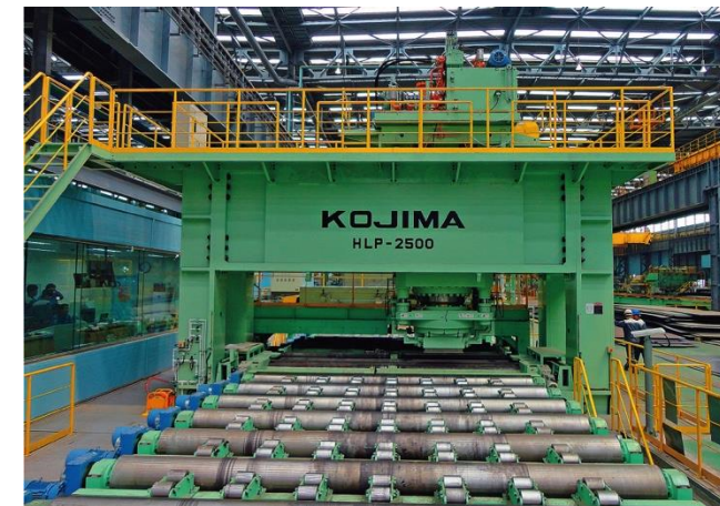
2,500T プレスレベラー テーブル 1,300 × 5,200mm 2,500T Press Leveler with Flatness Gauge Table Size 1,300×5,200mm
