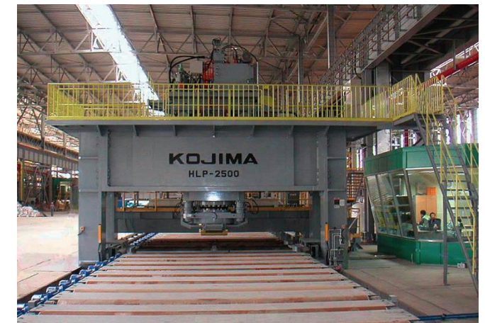
2,500T 平板矯正ライン テーブル 5,200 × 1,000mm 2,500T Press Leveler with Flatness Gauge Table Size 5,200×1,000mm
