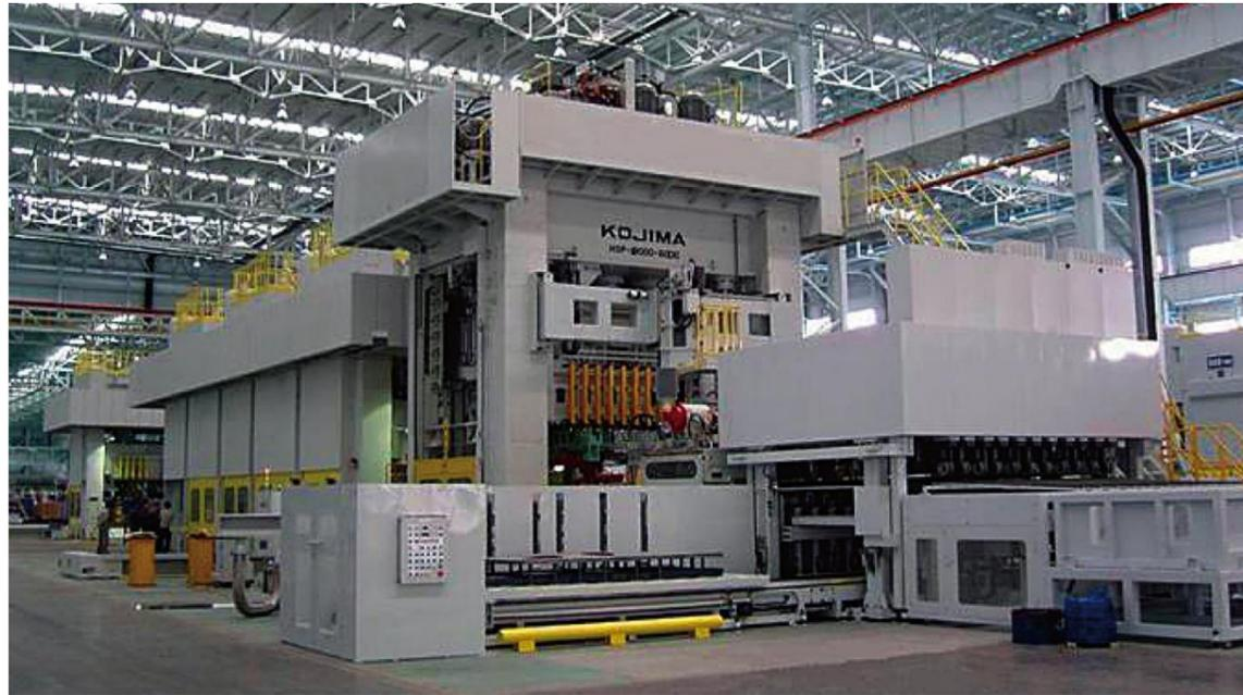
1,800T/600T 高速油圧リードプレス/単動金型、複動金型対応/15S.P.M
