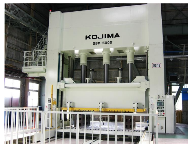
500T トライ兼ダイスポットティングプレス 500T Try & Die Spotting Press
