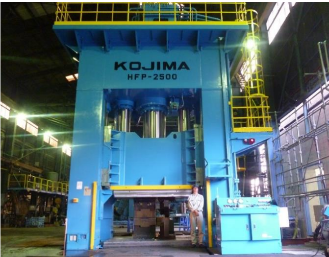
25000kN Hydraulic Forging Press 【Table Size】2,900 × 2,000mm
