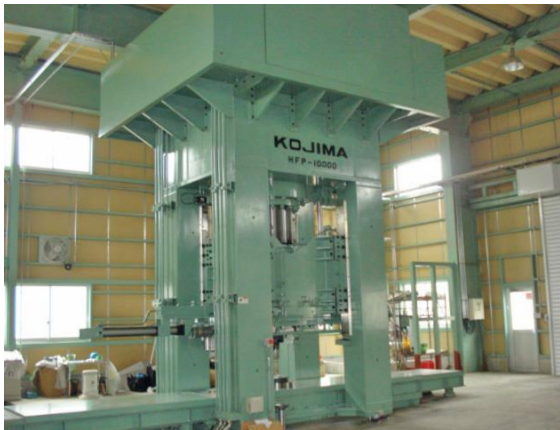
10000kN Hydraulic Forging Press 【Table Size】2,600 × 1,000mm
