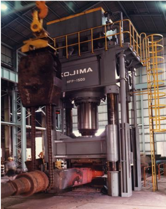
15000kN Four-Column Forging Press 【Table Size】1,500 × 3,000mm
