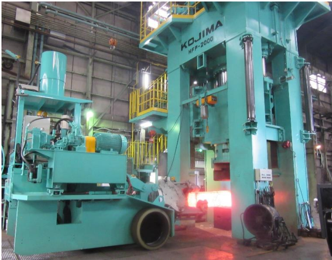
20000kN Hydraulic Forging Press 【Table Size】1,500 × 5,000mm
