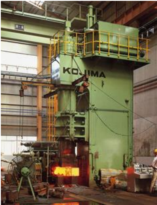
7500kN C-Frame Type Forging Press 【Table Size】3,100 × 1,000mm
