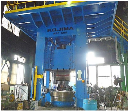
5000kN Hydraulic Forging Press 【Table Size】φ1290
