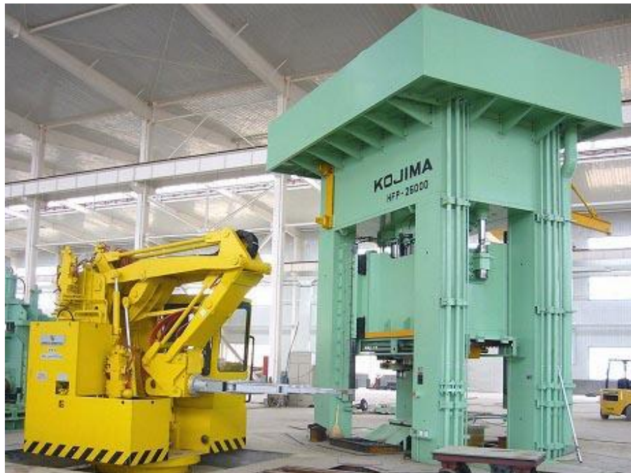
25000kN Hydraulic Forging Press 【Table Size】3,250 × 1,500mm
