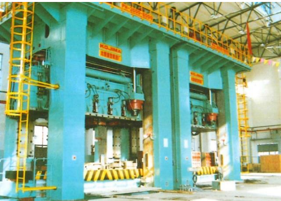
20000kN × 2 Coupled Frame Type Chassis Forming Press 【Table Size】 6,000×1,900mm × 2
