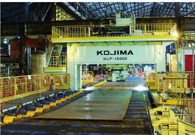
No.5 15000kN Press Leveler 【Table Size】5,000 × 3,200mm
